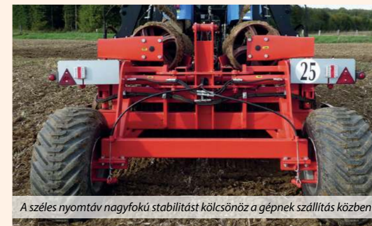
ROLLMOT henger simítóval, hidraulikus támasztólábbal és LED világítással
