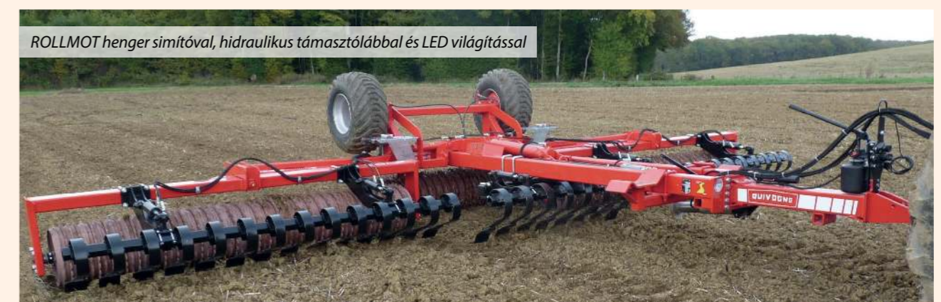
A széles nyomtáv nagyfokú stabilitást kölcsönöz a gépnek szállítás közben
