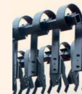
Lazító kések a kopólapok helyett
