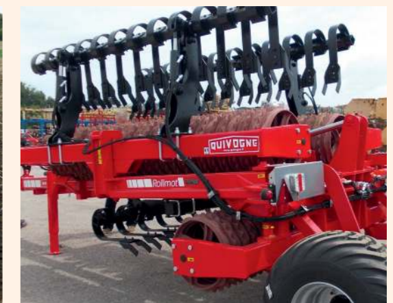
A széles nyomtáv nagyfokú stabilitást kölcsönöz a gépnek szállítás közben
